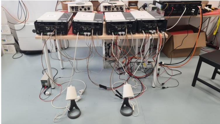
Una vez confirmado el correcto conexionado de alimentación y comunicación entre inversores, procedemos a su programación, para esto es importante que el interruptor ON/OFF esté apagado (OFF).
